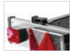
Schnellspanverschluss an der ausziehbaren Lichtleiste zur Arretierung
