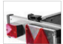
Schnellspanverschluss an der ausziehbaren Lichtleiste zur Arretierung
