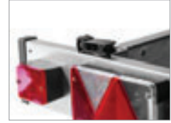
Schnellspanverschluss an der ausziehbaren Lichteiste zur Arretierung
