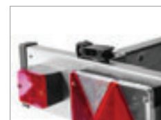
Schnellspanverschluss an der ausziehbaren Lichtleiste zur Arretierung
