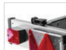
Schnellspanverschluss an der ausziehbaren Lichtleiste zur Arretierung
