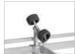
Mehrfach verstellbare Premium Super-Rollen mit Soft-Top-Beschichtung
