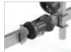
Verstärkte und höhenverstellbare Kiehlrollen
