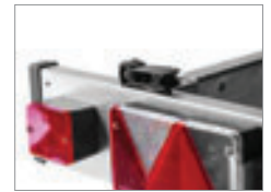
Schnellspanverschluss an der ausziehbaren Lichtleiste zur Arretierung
